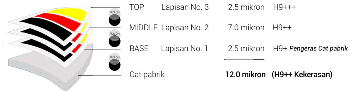
Ceramic Coating Trinity Fusion didasarkan pada polimer silikon-nitrogen dan ceramic yang berasal dari reaksi dichlorosilane dengan amonia. Platform kimia ini lebih mahal tetapi memberikan daya tahan yang jauh lebih dan merupakan keharusan untuk memenuhi harapan pelanggan / atau untuk menghindari keluhan pelanggan.
